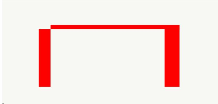
Telaio trasversale ad un piano: diagramma degli Sforzi Normali
