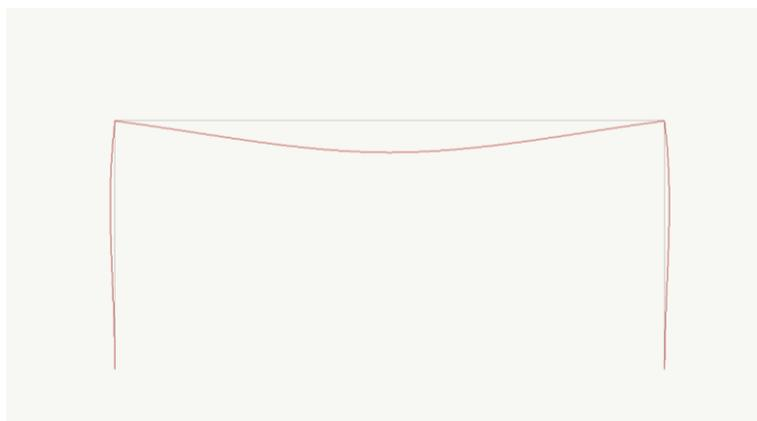
Telaio trasversale ad un piano: deformata (SLE - Rara)
