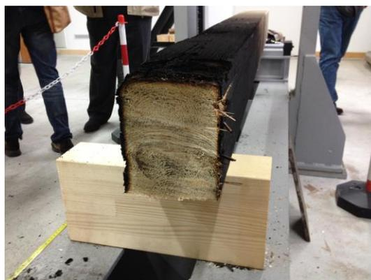
La parte interna della sezione trasversale (intatta) di una trave esposta al fuoco per 30 minuti.
