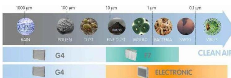
Fig. 4: Efficienza di filtrazione delle principali tecnologie
