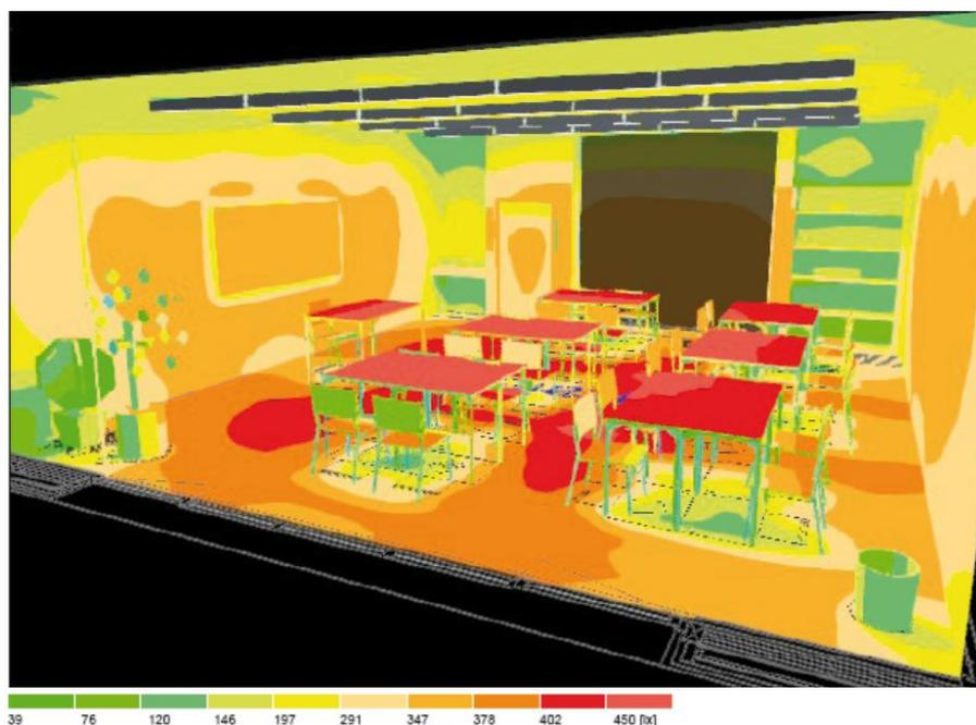
Fig. 7: Studio preliminare dei livelli di illuminamento di una delle aule del plesso scolastico
